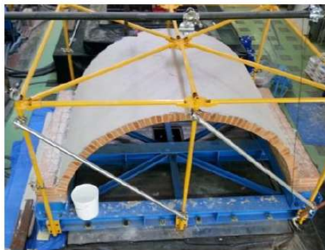
Figura 1. Illustrazioni di dettaglio delle configurazioni d'impasto nelle volte rinforzate con CRM (a) all'estrovasso e (b) all'infrodasso.
